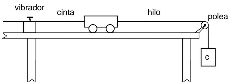
Para registrar las características del movimiento del carrito se une a él una cinta de papel que pasa por un “vibrador”. A medida que el carrito se desplaza, el vibrador imprime marcas sobre la cinta a intervalos iguales de tiempo.
