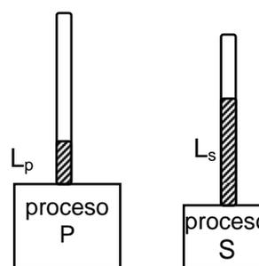
Cada vez que la columna de mercurio alcance los largos  $L_P$  o  $L_S$  diremos que la temperatura detectada es  $t_P$  o  $t_S$  según corresponda. Si la columna de mercurio alcanza un largo  $L$  tal que  $L_P < L < L_S$  , la temperatura detectada  $t$  está
