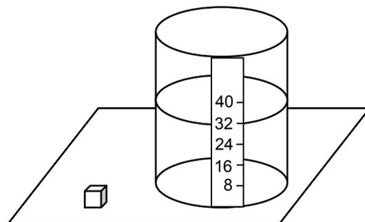
Efectúe esta operación varias veces; obtiene así un “frasco graduado”, en el cual un cierto volumen de agua se lee directamente en la cinta, según sea el nivel que alcance el agua.
