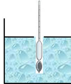
El tubo queda más o menos sumergido según sea la densidad del líquido que se estudia. El valor de la densidad se lee directamente en una escala graduada en unidades apropiadas, por ejemplo  $[\text{g}/\text{cm}^3]$ , colocada en el tubo. Tal vez usted ha visto usarlos como “lactómetros” o como indicadores del “estado de carga” de una batería o del “grado alcohólico” de bebidas.
