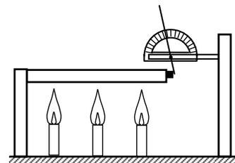
Caliente la barra; use, por ejemplo, algunos mecheros. Obtenga una relación entre la lectura en el transportador y el aumento del largo de la varilla. Efectúe mediciones y cálculos para determinar el coeficiente de expansión lineal de la varilla.
