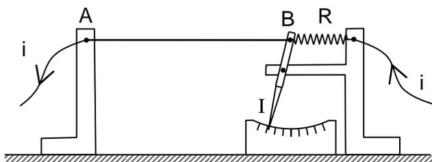
Un hilo fino, por ejemplo de cromo-níquel, va de A a B y es mantenido tenso por un resorte R. El hilo se calienta por medio de una corriente eléctrica. La variación de temperatura produce un alargamiento del hilo. La acción del resorte permite detectar el alargamiento mediante la aguja indicadora I.
