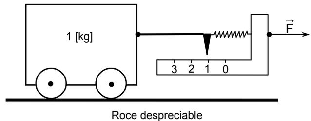
Un resorte calibrado de esta manera se llama *dinamómetro* o *balanza de Newton*.
