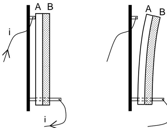
El doblamiento de un par bimetalico se puede usar para abrir o cerrar circuitos eléctricos cuando un sistema ha llegado a una temperatura prefijada. Pares bimetalicos encuentran aplicación en refrigeradores, calentadores de agua, señalizadores de viraje en automóviles, y otros aparatos.
